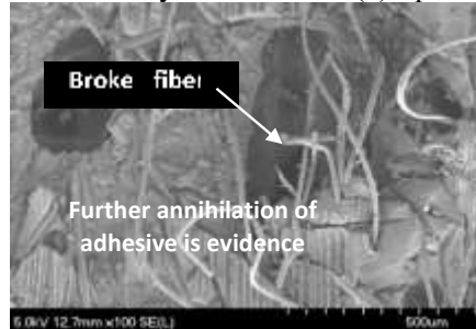
(d) Specimen subjected to 1000 cycles
