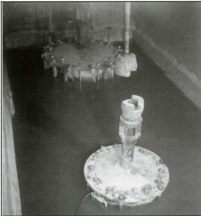
Fig. 11. Le moulin Légaré, Saint-Eustache, Qc. Turbine Leffet au fond, turbine Hale au premier plan. (Jean Bélisle, Maître d'œuvre de l'histoire, 1-12, 1999)
